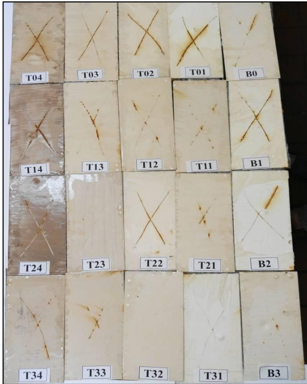
Fig. (9): ZnPO4 primer with HETCA-modified alkyd resins
